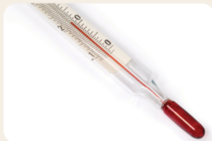
Доњи део (резервоар) алкохолног термометра
