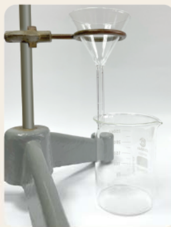
Исправно састављена апаратура за филтрацију
