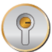
Слика 3.2.5: Квака на вратима је један од примера за полугу. Кроз тачку О пролази оса ротације, која је нормална на врата.
