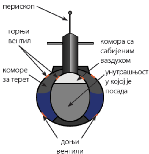
Слика 3.6.9: Принцип рада подморнице.
