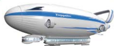
Слика 3.6.7: Цепелини су балони испуњени углавном хелијумом (некада се користио водоник). Густина хелијума је 6,5 пута мања од густине ваздуха, што омогућава њихов лет. У гондоли која је причвршћена за доњи део цепелина има места за око двадесетак особа. Такође се користе и за пренос терета као што су делови мостова, делови термоцентрали и хидроцентрали или сличне машинске конструкције.
